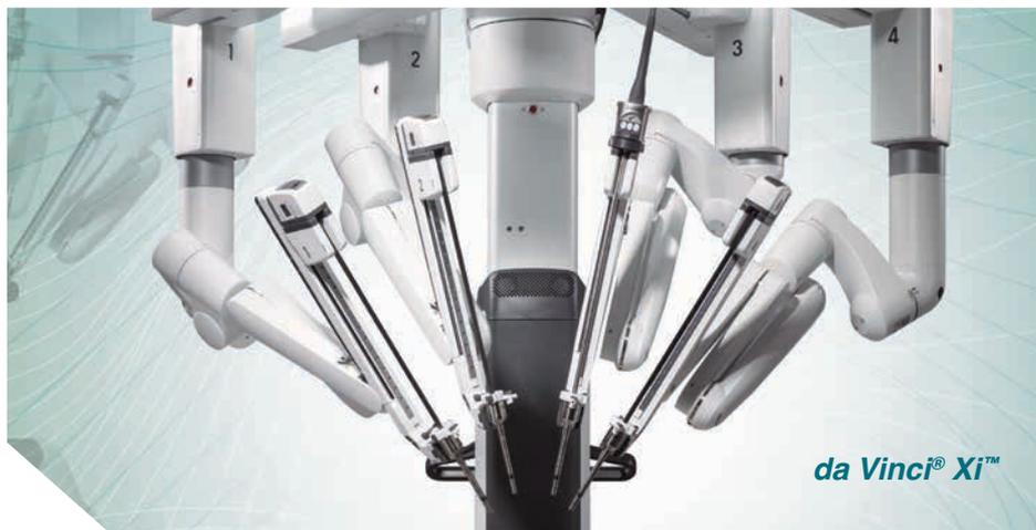
Petite merveille de la robotique, *da Vinci® Xi™* est un véritable outil chirurgical équipé d'un système de commande déporté du patient. Le chirurgien travaille sur une console opératoire lui permettant d'articuler les bras du robot et de gérer leurs mouvements sur le corps du patient grâce à des instruments chirurgicaux spécifiques et une caméra endoscopique.
